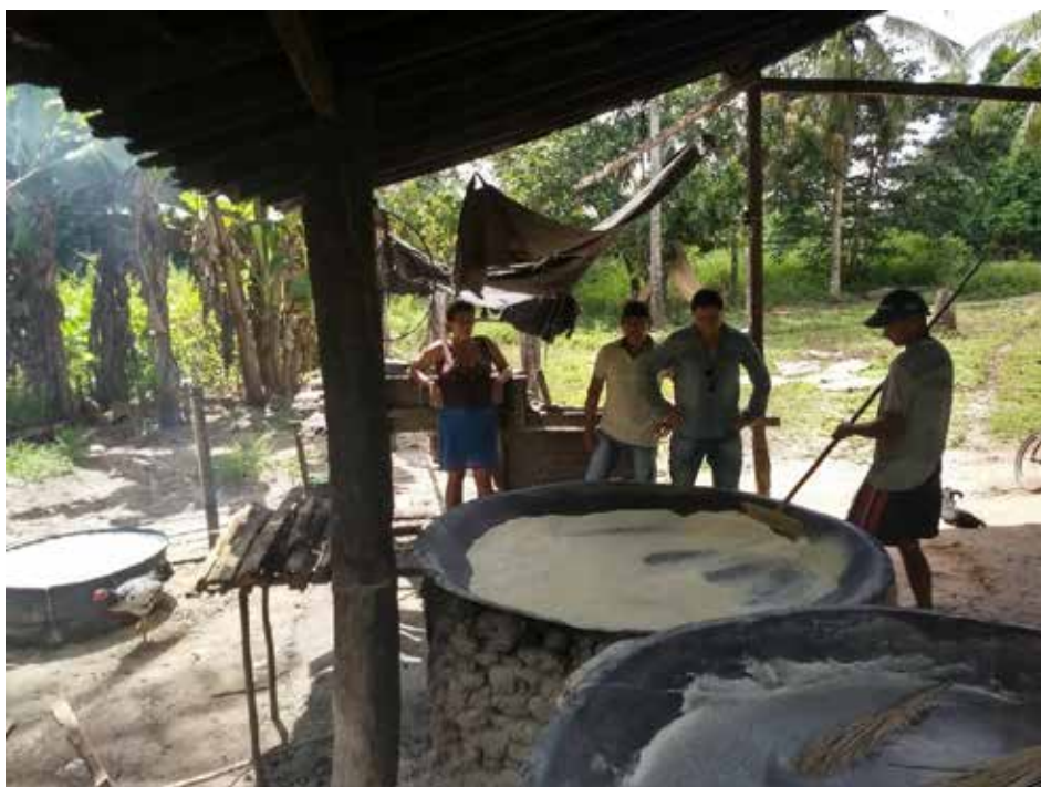
Figura 12. Casa de farinha com tanque de lavagem de mandioca (esquerda) para erradicar lavagem em leitos de rios e evitar contaminação dos mananciais d'água. Polo Rio Capim, PA.
