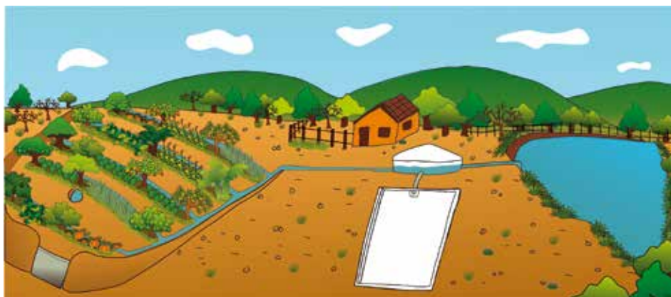
Figura 7. Integração de tecnologias hídras: barragem subterrânea, cisterna calçada e barragem de água superficial. Ilustração: Rosely Camilla Pereira.
